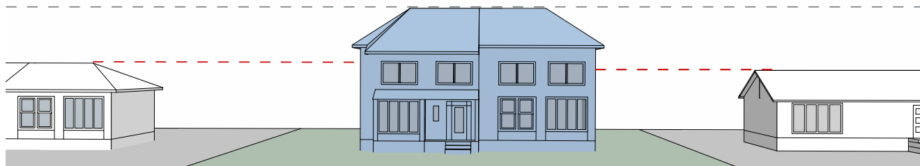
Figure 15 : Exemple d'une mauvaise atténuation entre les hauteurs
